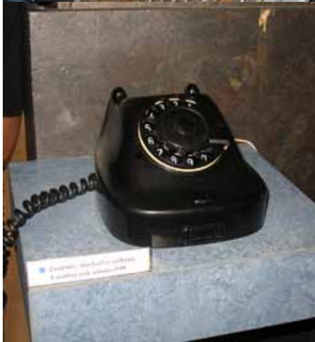
Uhlíkový mikrofon vynalezl Thomas Alva Edison. Objevil, že uhlíková zrnka, stlačená mezi kovové desky mají elektrický odpor nepřímo úměrný tlaku. Pokud na jednu z desek působí zvukové vlnění, mění se i proud, protékající zrnky mezi deskami. Kvalita je dostačující pro hovor. Objev vedl k vývoji uhlíkových mikrofonů, které byly základem telefonů po více než 100 let a které se používají dodnes.
